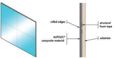
**INTERIOR ROLLED PIN EDGE**
